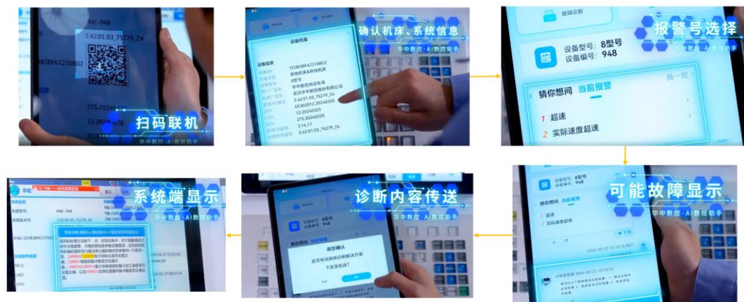
图表46：华中9型数控系统包含了基于大模型技术的故障诊断功能
