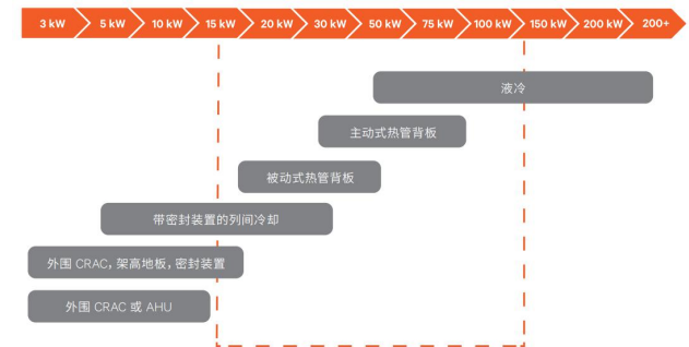
图 6：当机柜密度大于 20kW 时需要采用液冷散热
